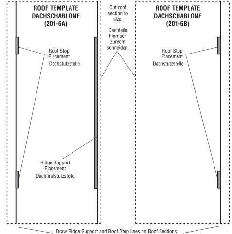
Linien zur Ausrichtung des Dachfirststutzen sowie der Dachstutzen an den Dachteilen markieren.
